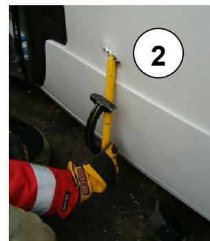
1. Öffnung im unteren Drittel der Motorhaube schaffen – Bügel (Hebelmesser) in den Spalt der Motorhaube einsetzen - Öffnung einschneiden.
